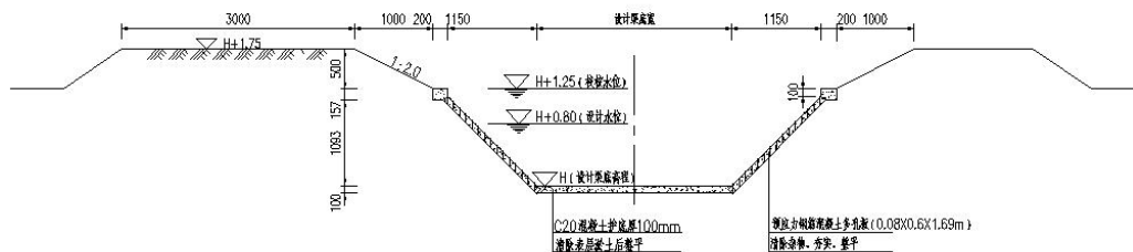
图 2-3 渠道护砌标准断面图
