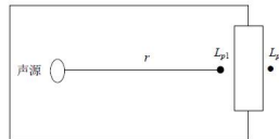
图 4-5 室内声源等效为室外声源图例
